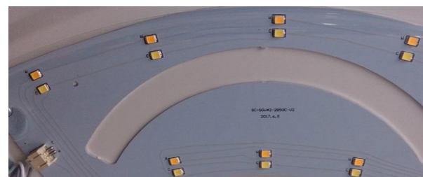
Фиг. 6. Разположение на част от LED източниците от групи „W“ и „C“ върху платка в осветителя
