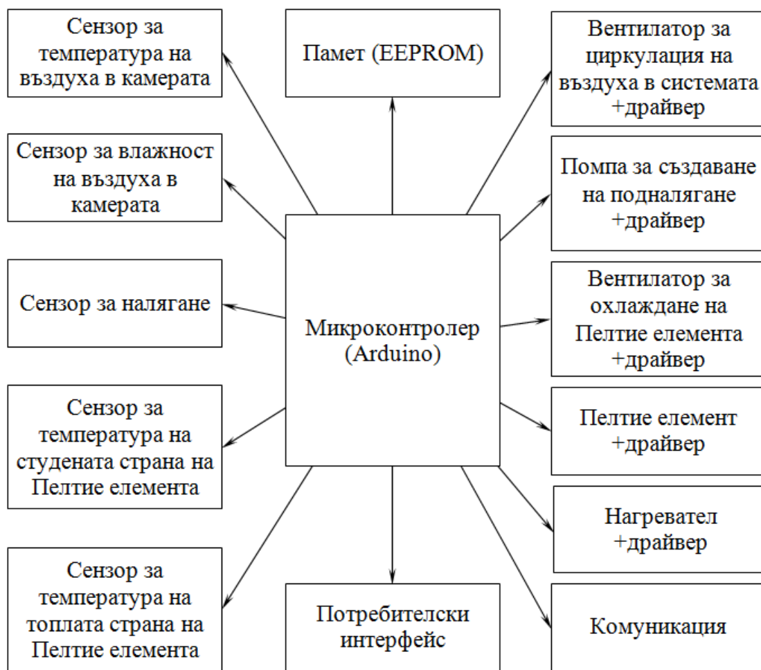
Фиг. 1. Функционална блокова схема на разработваната сушилна
