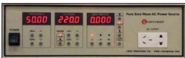
Фиг. 2. Стабилизирани синусоидални променливо-токови източници на напрежение LSP-500VAR
