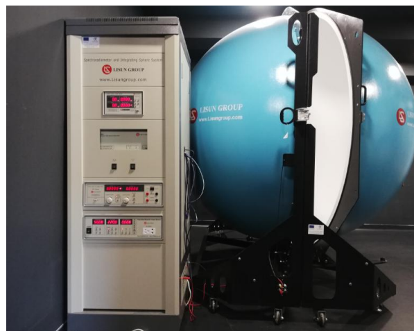
Фиг. 8. Външен вид на измервателния комплект и интегриращата сфера, позиционирани в лабораторията
