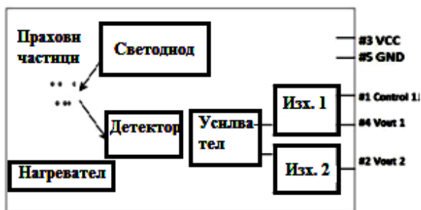
Фиг. 4. Вътрешна архитектура на сензор DSM501
