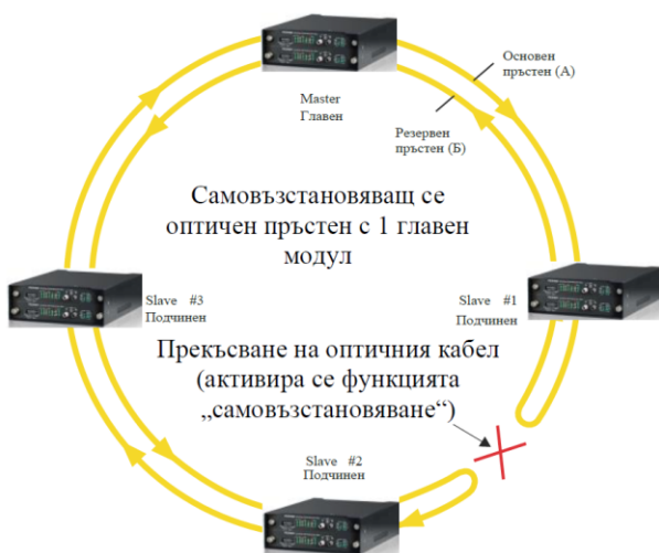
Фиг. 8. Преконфигурация при прекъсване на пръстените
