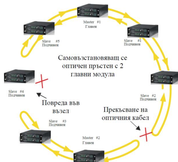
Фиг. 9. Преконфигурация при прекъсване на пръстените и повреда на възел
